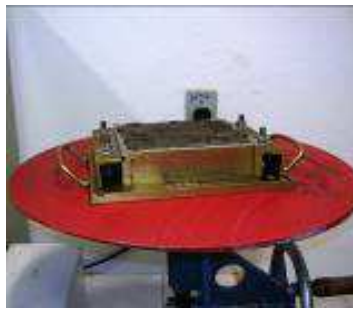
Figura 2: Moldagem dos corpos-de-prova, empregando-se mesa de adensamento
