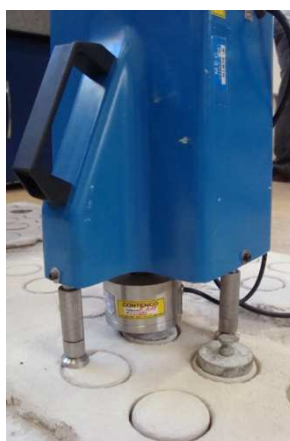
Figura 4: Execução do ensaio, empregando-se aparelho de arrachamento
