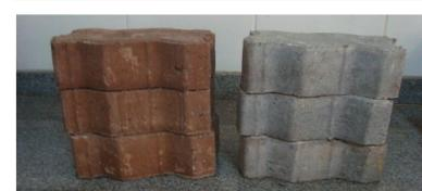
Fig. 3: Blocos de pavimentação produzidos
