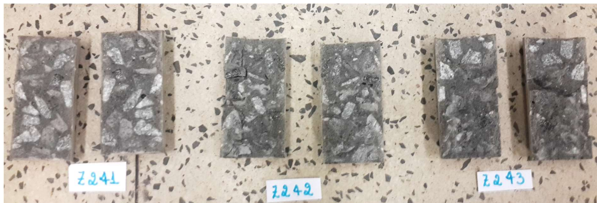
Figura 3. Corpos de prova \varnothing 50 \times 100 mm divididos ao meio (C35).
