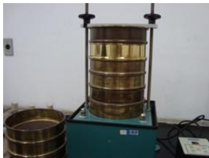
Figura 3: Peneiras utilizadas no ensaio de granulometria
