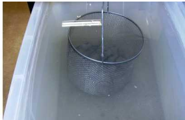
Figura 5: Ensaio de massa específica - agregados miúdos e graúdos.
