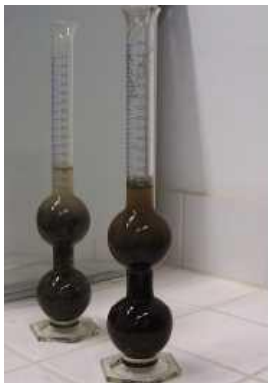
Figura 5: Ensaio de massa específica - agregados miúdos e graúdos.
