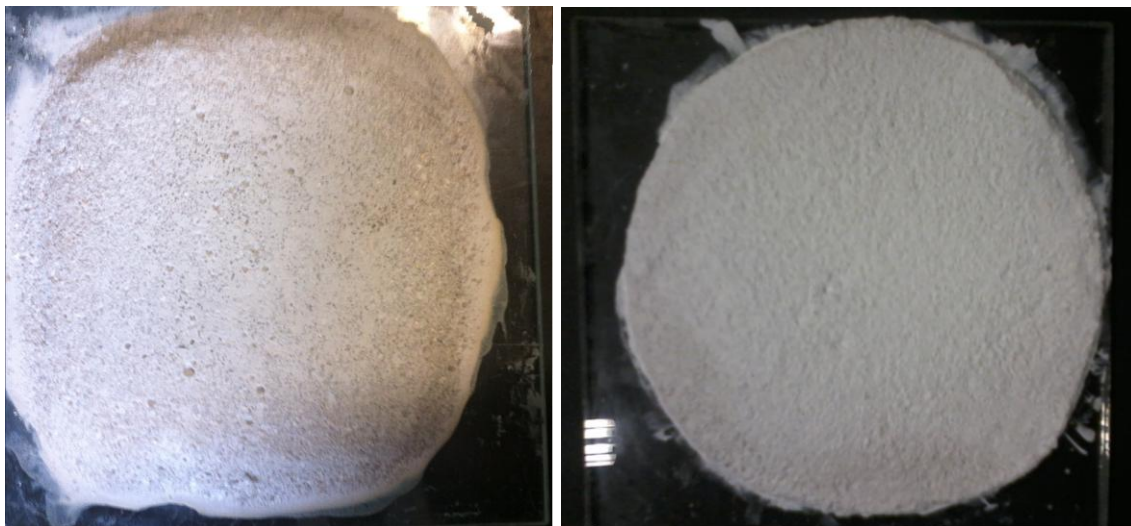
Figura 6 - Resultados dos ensaios para determinação da estabilidade (a) argamassa de escória e (b) argamassa de cal
