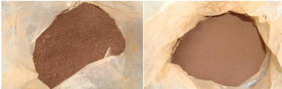
Figura 1 - Resíduo da barragem após secagem retido na malha 150µm e passante na peneira
