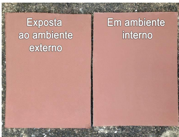
Figura 8 – Resultado do ensaio de durabilidade das placas após 6 meses – Traço de PVA.
