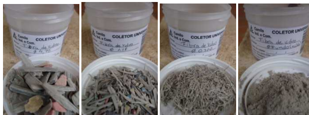
Figura 2 - Materiais resultantes do processamento do resíduo de MCFV.
