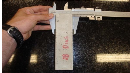
Figura 5 – Utilização do paquímetro para determinação das dimensões dos Cp's.
