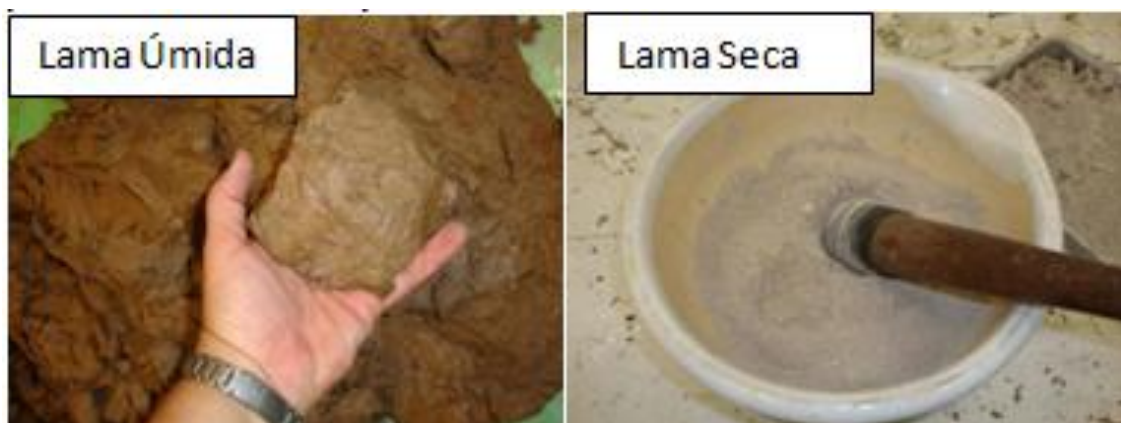
Figura 3: Resíduo de granito em seu estado úmido e seco.
