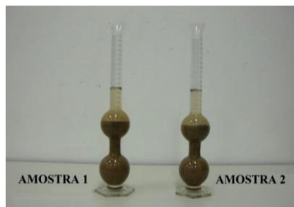
Figura 2 – Ensaio de massa específica utilizando o frasco de Chapman.
